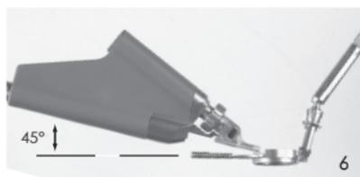
在吸環的導軌中插入刀頭時，機頭應當距吸環的金屬螺紋軸呈 45 度角，以防止軸觸碰刀頭和分離器組合體 (6)。
