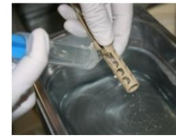
Avec la seringue de 5 ml et la canule, injecter la solution du bain 5 fois via le lumen
