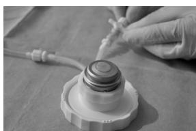
Centrer précisément le greffon sur le puits de la chambre et placer la cloche en faisant correspondre l'encoche de la cloche avec l'ergot de la base. Vérifier le centrage parfait du greffon puis bloquer la cloche en vissant fermement l'écrou blanc.
