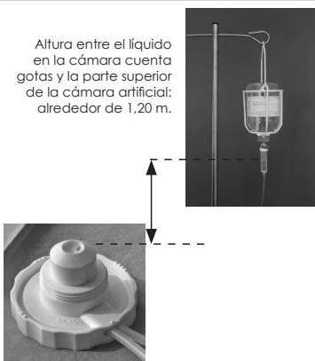
**Levante la botella a una altura de 1,20 m entre la cámara cuenta gotas y la parte superior de la cámara artificial (córnea) para garantizar que se obtengan 90 mmHg de presión.**
