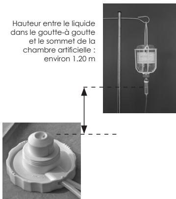
**Placer la bouteille de façon à ce que le niveau de liquide dans la «chambre compte gouttes» de la ligne d'infusion se trouve à une hauteur de 1.20 m du sommet de la chambre artificielle (cornée) afin de garantir une pression de 90mmHg.**
