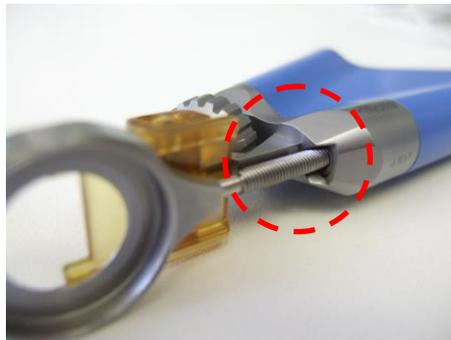
图 10: 吸力环的螺纹杆与马达对齐.
